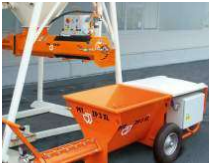
Abb. 35: ZP 3 mit Material beschicken
