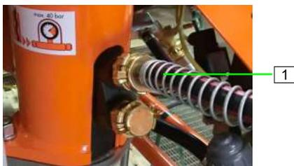
Abb. 74: Wasserschlauch anschließen
