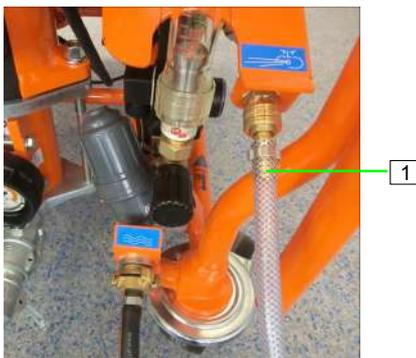
Abb. 43: Luftschlauch anschließen
