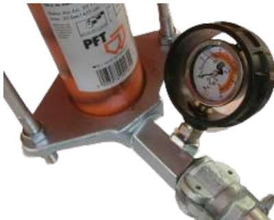
Abb. 16: Mörteldruckmanometer
