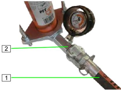
Abb. 41: Mörtelschlauch anschließen
