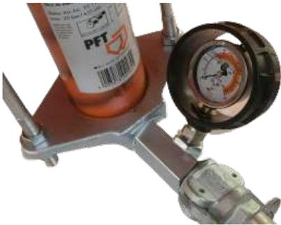
Abb. 26: Mörteldruckmanometer
