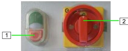
1. Maschine durch Drücken des roten Drucktasters (1) Steuerspannung "AUS" ausschalten.
