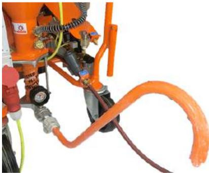
Abb. 52: Konsistenzprüfrohr
