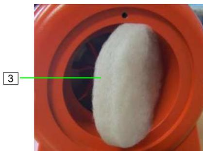
Abb. 87: Filter des Luftkompressors
