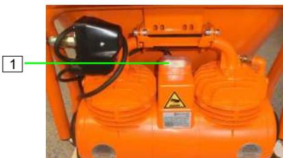
Abb. 61: Luftkompressor ausschalten
